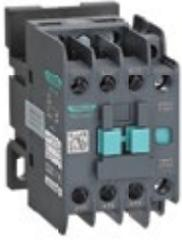
TGC1 系列交流接触器（以下简称接触器），外观精美，体积小。主要用于交流 50Hz（或 60Hz）、额定工作电压至 690V，在 AC-3 使用类别下额定工作电压 380V 时，额定工作电流至 95A 的电力系统中，供远距离接通和分断电路之用，并可与适当的热继电器组成电磁起动器以保护可能发生过大负荷的电路，接触器适宜于频繁地起动和控制交流电动机。
